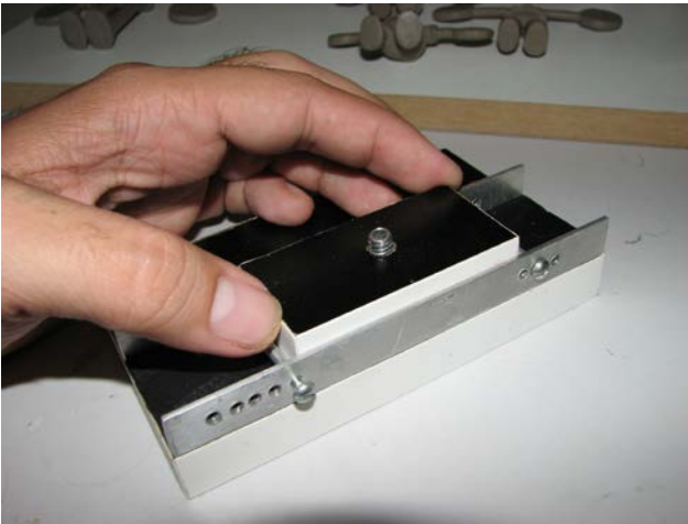
Figura11 - Mini travelling de deslocamento da câmera
