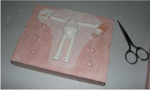
Figura 9 - Boneco de silicone sendo retirado do molde
