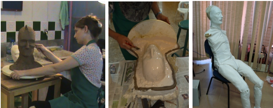
Figura 2: Personagem robótico; a. Modelagem da cabeça; b. Fabricação do molde; c. Montagem do corpo.
